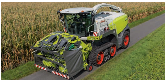
Der Jaguar 960 Terra Trac von Claas bietet eine Transportbreite von unter drei Meter.
